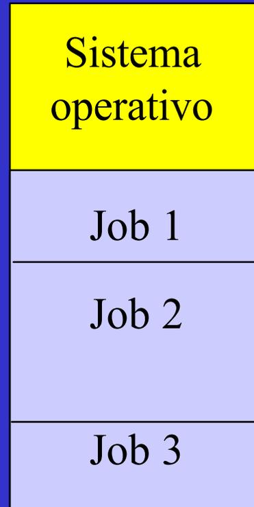
Configurazione della memoria centrale in sistemi batch multiprogrammati
