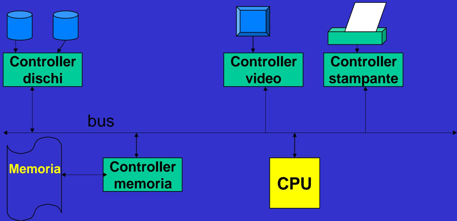
**Controller:** interfaccia HW delle periferiche verso il bus di sistema
