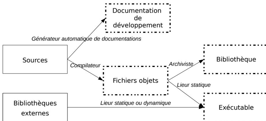
FIGURE 1 – Chaîne standard de compilation : les produits sont entourés en pointillé.
